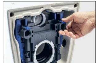
Eine neuartige Befestigungstechnik ermöglicht eine schnelle Montage und gestattet einen Spielraum von vier Zentimetern (+3/-1) in der Montagehöhe, so dass diese auch nach der Installation des Spülkastens noch nachjustiert werden kann.
