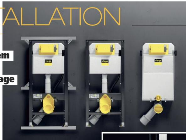
Um die Montage der „Viega Prevista“-Vorwandelemente zu vereinfachen, hat Viega gemeinsam mit Produkt-Designern ein spezielles Farbkonzept entwickelt: Alle beweglichen und von Hand montierbaren Bauteile sind gelb eingefärbt. Der Fachhandwerker erkennt also auf den ersten Blick, wo im wahren Sinne des Wortes Hand angelegt werden muss. Dies betrifft zum Beispiel die Schieber zur Voll- und Teilsplülmengenanlage, die einstellbare Spülstromdrossel oder die Halterung des Füllventils.
