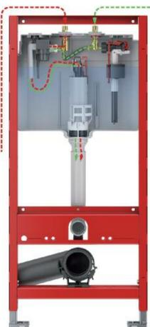
Mit dem TECEprofil WC-Modul mit integrierter Hygienespülung lassen sich Stagnationen sowohl im Kalt- als auch im Warmwassernetz vermeiden. Das Spülwasser wird dabei direkt über den Spülkasten entsorgt. Das Modul wird als letzter Verbraucher in eine durchgeschliffene Reiheninstallation eingebunden. Dank der Platzierung im Spülkasten entfallen zusätzliche Rohrwege und Revisionsöffnungen.
