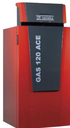
Technisch punktet das Gas-Brennwertgerät durch seinen speziell entwickelten Monoblock-Wärmetauscher aus Aluminium/Silizium. Zudem verfügt es über eine serienmäßige eingebaute Rückstromsicherung am Abgasaustritt für den sicheren Einsatz in einer Kaskade. Auch die Installation geht auf Grund der geringen Abmaße von 600 x 600 x
