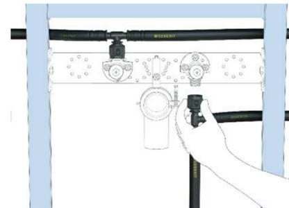
Thermisch entkoppelte Leitungsführung mit Geberit MasterFix.
