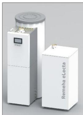
Das System eLecta 300 besteht neben dem Brennstoffzellen-Modul aus einem 300-Liter-Pufferspeicher, einer Hydraulikeinheit (im Puffervorbau integriert) und einem Gas-Brennwertgerät als Spitzenlastkessel. Dieser hat eine Leistung von 4,8 bis 20 kW und ist ebenfalls im Puffervorbau integriert. Die Warmwasserbereitung erfolgt über ein Frischwassermodul direkt aus dem Pufferspeicher. Damit ist das eLecta 300 optimal für den Einsatz in Ein- und Zweifamilienhäusern vorbereitet.
