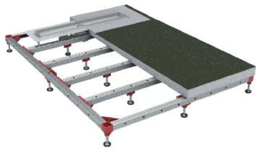
Die Verbindungselemente für die Außenprofilstreben sorgen durch Aufnahme von Druck- und Zugspannung auch für die gleichmäßige Lastverteilung im gesamten Rahmensystem.
