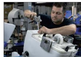
Die Bolzen zur Sitzbefestigung werden ab Werk fest in die Keramik eingegossen (Bild oben). Sie ermöglichen die exakte Positionierung von Sitz und Deckel. Dank der eingegossenen Befestigungsbolzen muss der WC-Sitz einfach nur aufgesteckt werden – fertig. Deckel und Sitz fluchten perfekt und die lästige Nachjustage entfällt.
